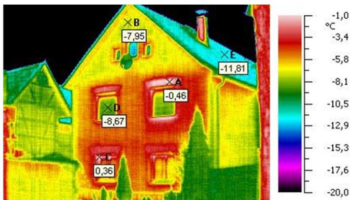
Abbildung 23: Der weiß bis rote Bereich zeigt den höheren Wärmeverlust am Fenster-/Wandanschluss und insbesondere an den Rollladenkästen (Bild: © www.bauthermografie-luftdichtheit.de)
