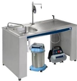
Die **Schlachthilfe** entfernt nach dem Öffnen der Fische die Innereien durch einen Vakuumsauger und trennt den Schlund durch ein Spezialmesser ab. Ein Nachbürsten des ausgeweideten Fisches ist bei richtiger Handhabung nicht erforderlich. Es können Fische von 200 - 1.300 g geschlachtet werden; die Stundenleistung liegt bei 400 - 500 Fischen. Für kleine Produktionsmengen nicht erforderlich.
