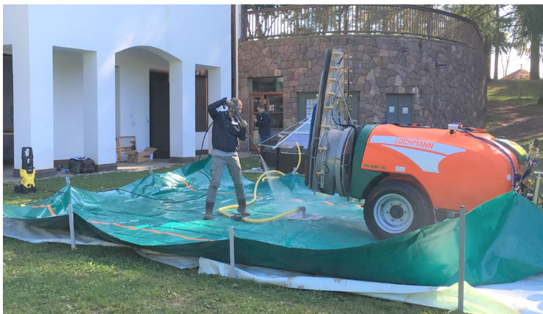
Immagine 10: Area di lavaggio mobile (telone) per la pulizia dell'irroratrice
