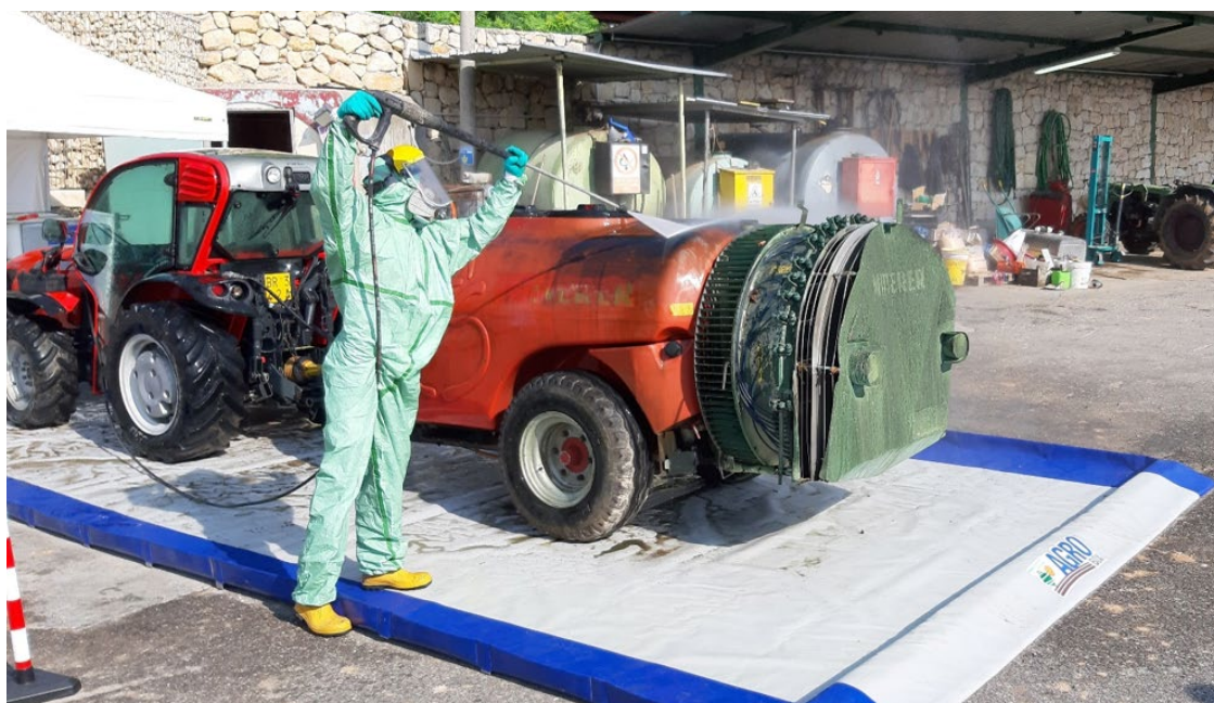
Immagine 11: Piazzola mobile presagomata per la pulizia di trattore ed atomizzatore
