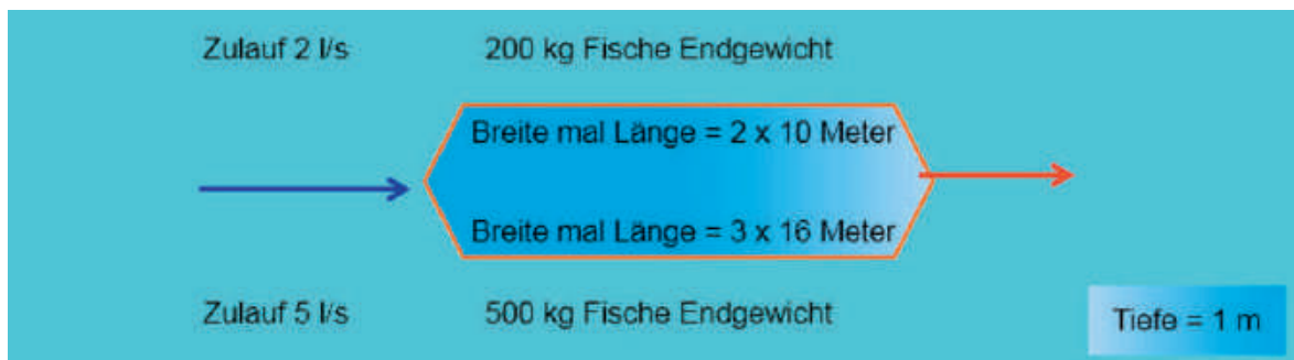
Abb. 8: Die Planskizze zeigt das Modell einer Speisefischproduktion mit Forellen und Saiblingen, wobei für eine tiergerechte Haltung eine Dichte von 10-20 kg Fischen pro m 3 Wasser nicht überschritten werden darf. Gleichzeitig wird der Grundsatz einer Haltung von höchstens 100 kg Fischen je 1 l/s Wasserzufluss eingehalten.
